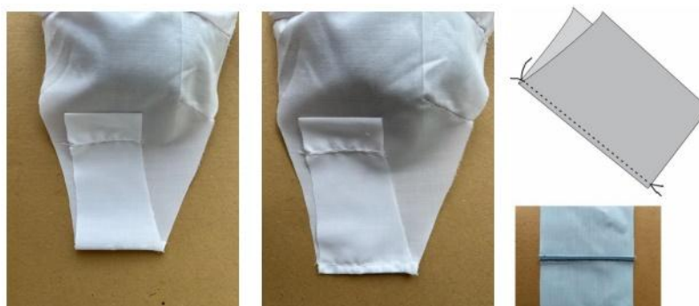
Figura 18 - Costura francesa finalizada, diagrama e amostra da costura ponto atrás.
