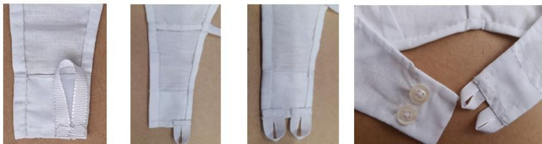
Figura 22 – Costuras de acabamento das costas do protótipo do sutiã.
