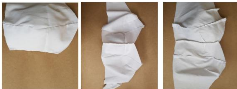
Figura 19 - Costura de união do meio da frente do protótipo do sutiã.
