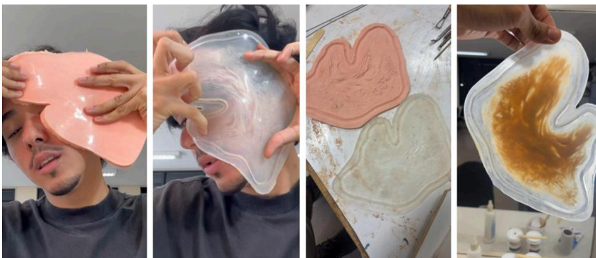
Figura 12. Moldes flexíveis com silicone à base de estanho (cor-de-rosa) e à base de platina (transparente)
